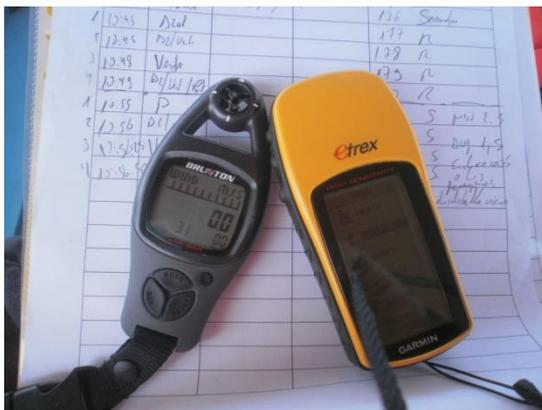
Fotografía N°21: GPS y Anemómetro
