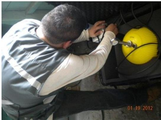
Fotografía N°25: Preparando el correntómetro S4A para la segunda campaña
