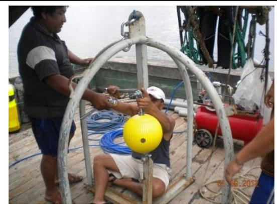
Fotografía N°30: Armado de la estructura de acero más el S4A
