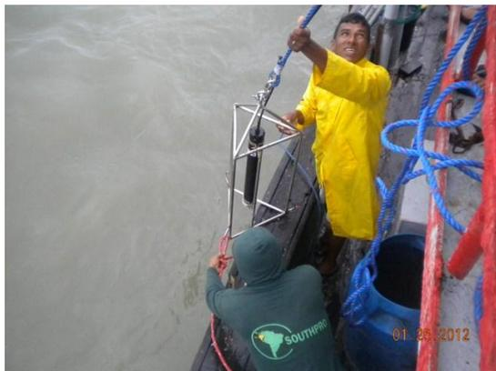
Fotografía N°33: Perfilador ADCP Aquadopp
