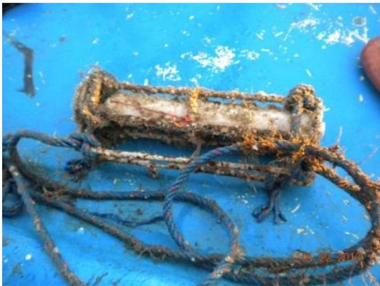
Fotografía N°55: Mareógrafo RBR 2050 retirado
