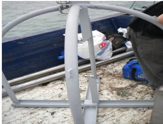
Fotografía N° 1: Estructura de acero del correntómetro S4A
