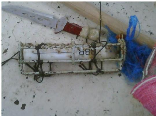
Fotografía N°51: Mareógrafo RBR 1050 retirado
