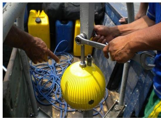
Fotografía N° 2: Instalación del S4 en la estructura de acero
