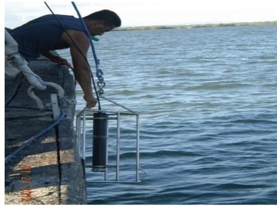
Fotografía N°44: Alce del ADCP para el traslado hacia otra estación
