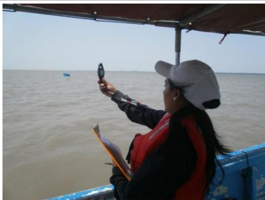
Fotografía N23°: Medición de magnitud de vientos en el área de estudio con ayuda de un anemómetro
